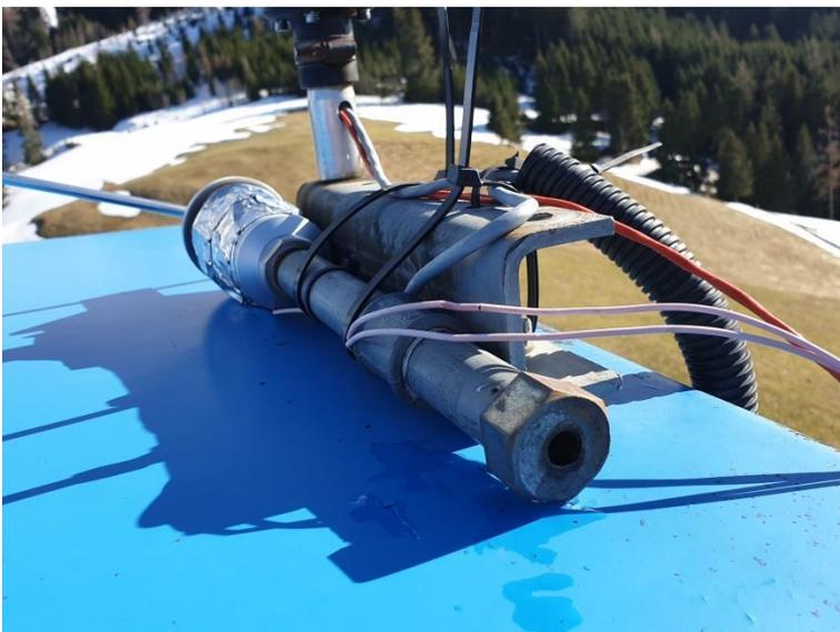
Windrichtungsgeber prov. Fixiert, hing vorher am Kabel
