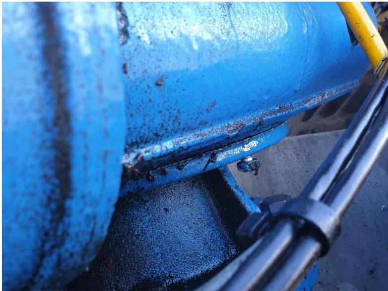
Lose Schrauben unten an Schneckengetriebe
